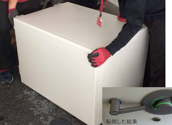
扉面を下にして 転倒した金庫
