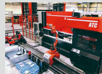
ベンディングロボットシステム 材料つかみから、曲げ加工、搬出、金型の交換まで自動で行う
