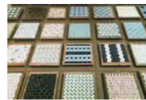
貼り板 モザイクタイルの出荷前の仕上げ加工である紙貼り作業は、今もこの貼り板を使う
